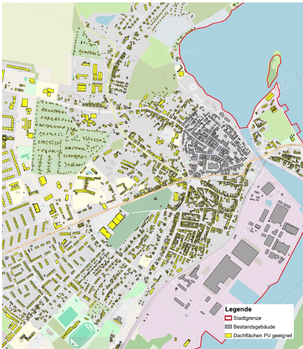
Abbildung 5.2.8-2: Ausschnitt Dachbelegung mit PV-Modulen (Quelle: SHP)
