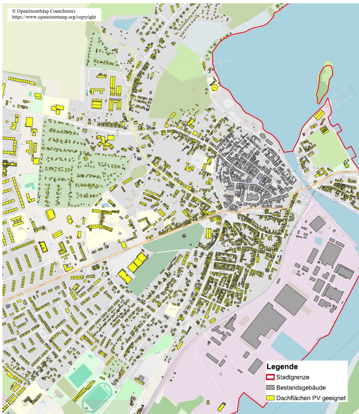
Abbildung 5.2.8-2: Ausschnitt Dachbelegung mit PV-Modulen (Quelle: SHP)
